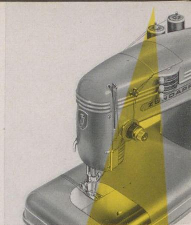
Ein besonderer Vorteil: Schon mit der ZÜNDAPP-Geradstich-Nähmaschine kann man dank des querstehenden Greifers Biesen nähen (wie sonst nur mit einer Zick-Zack).
